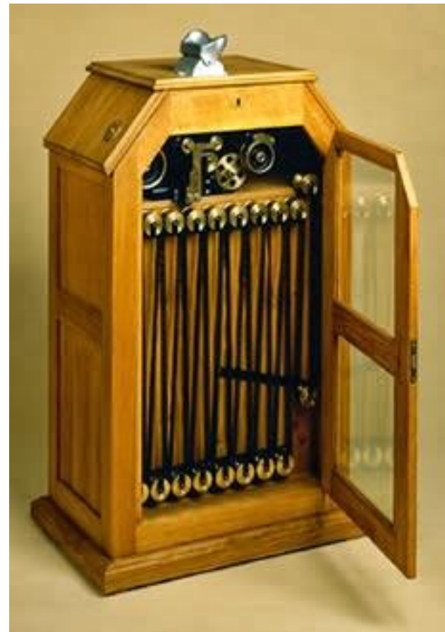
Il KINETOSCOPIO è un apparecchio ideato da Thomas Edison nel 1888, ed è il precursore di un proiettore cinematografico.
